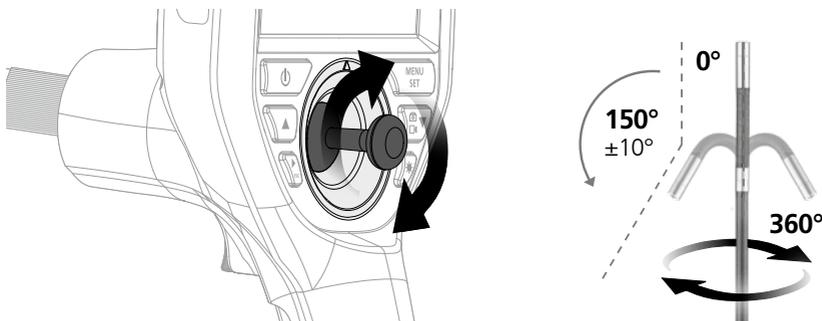
Die maximale Winkelstellung des 3D-Kamerakopfes beträgt im Neuzustand werksseitig 150°, mit einer Toleranz von  $\pm 10^\circ$ . Dazu muss sich die Kamerasonde in völlig gerader Lage befinden, also ohne unnötige Kurven oder Biegungen. Durch normalen mechanischen Verschleiß kann sich die maximale Winkelstellung im Laufe der Lebensdauer des Produkts verringern.
