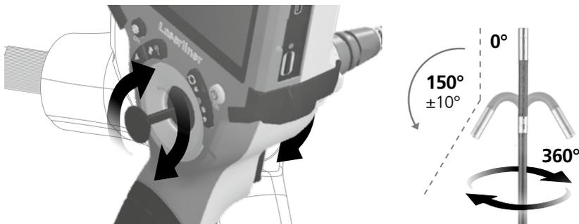
Maximální úhlová poloha 3D hlavy kamery v novém stavu je  $150^\circ$  s tolerancí  $\pm 10^\circ$ . Přitom musí být sonda kamery ve zcela rovné poloze, tedy bez zbytečných nerovností nebo ohybů. Běžné mechanické opotřebování může během životnosti výrobku snížit maximální úhlovou polohu.
