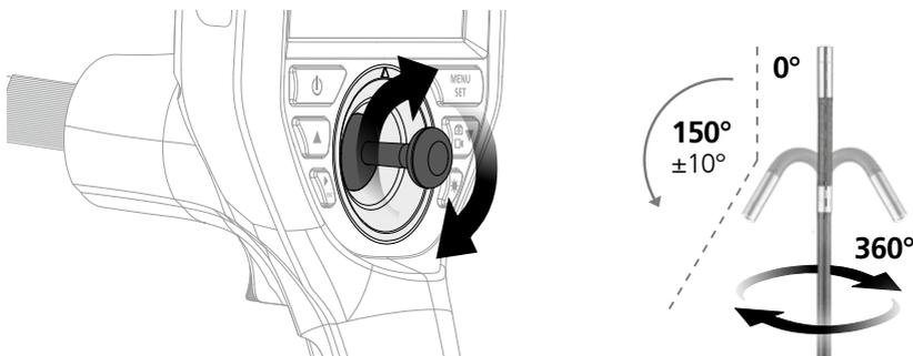
La posición angular máxima del cabezal de la cámara 3D, nuevo de fábrica, es 150° con una tolerancia de  $\pm 10^\circ$ . Para ello, la sonda de la cámara debe estar en línea recta, es decir, sin curvas ni ángulos innecesarios. El desgaste mecánico normal puede reducir la posición angular máxima durante la vida útil del producto.
