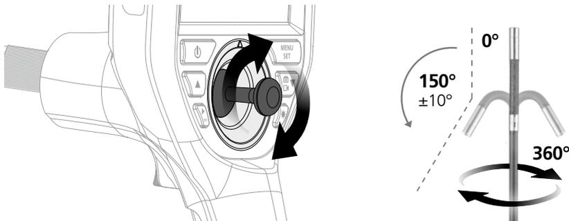
Maksimalno namještanje kuta 3D glave kamere u novom stanju tvornički iznosi 150°, uz dopušteno odstupanje od  $\pm 10^\circ$ . U tu se svrhu sonda kamere mora nalaziti u potpuno ravnom položaju, dakle bez nepotrebnih krivulja ili savijanja. Tijekom životnog vijeka proizvoda može doći do smanjenja maksimalnog kutnog položaja uslijed normalnog mehaničkog trošenja.
