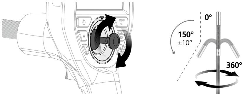
I ny tilstand fra fabrikk er maksimal vinkelposisjon for 3D-kamerahodet 150°, med en toleranse på  $\pm 10^\circ$ . For dette må kamerasonden være i helt rett posisjon, dvs. uten unødvendige kurver eller bøyninger. Normal mekanisk slitasje kan føre til at den maksimale vinkelposisjonen reduseres i løpet av produktets levetid.
