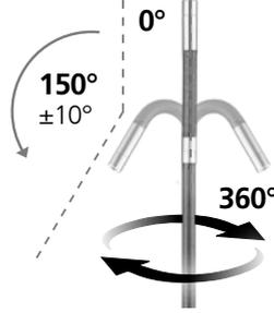
Yeni olduğunda 3D kamera kafasının maksimum açıl konumu fabrikada  $\pm 10^\circ$  toleransla  $150^\circ$ 'dir. Bunun için kamera sondası tamamen düz bir konumda olmalıdır, yani gereksiz kıvrımlar veya bükülmeler olmamalıdır. Normal mekanik aşınma ve yıpranma, ürünün kullanım ömrü boyunca maksimum açıl konumu azaltabilir.
