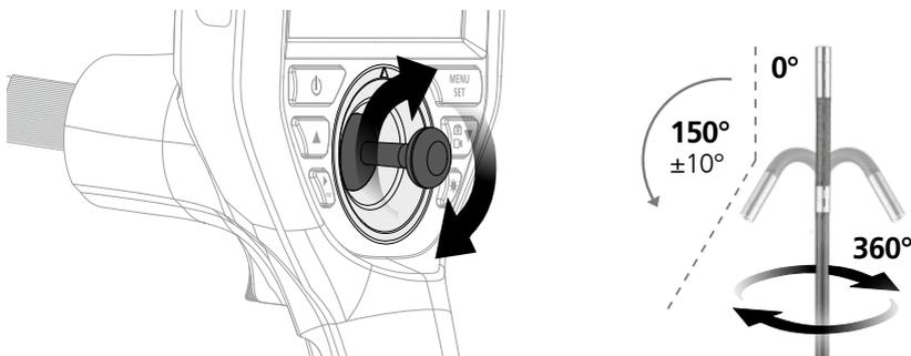
Максимальное угловое отклонение головки 3D-камеры в новом заводском состоянии составляет 150° с допуском  $\pm 10^\circ$ . Для этого зонд камеры должен находиться в абсолютно прямом положении, т.е. без излишних изгибов и поворотов. Из-за нормального механического износа максимальное угловое отклонение может уменьшаться в течение срока службы изделия.
