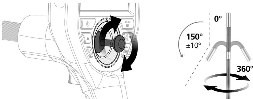
カメラヘッドの工場出荷時の最大可動角度は150°(許容誤差±10°)です。最大角度で可動させるためにはカメラケーブルが完全な直線(曲線やカーブがない)状態にする必要があります。最大可動角度は製品寿命や通常使用による機械的な摩耗・損傷により減少する可能性があります。
